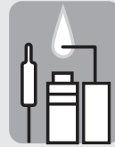
Abb. 4a: Wächterflamme brennt falsch
